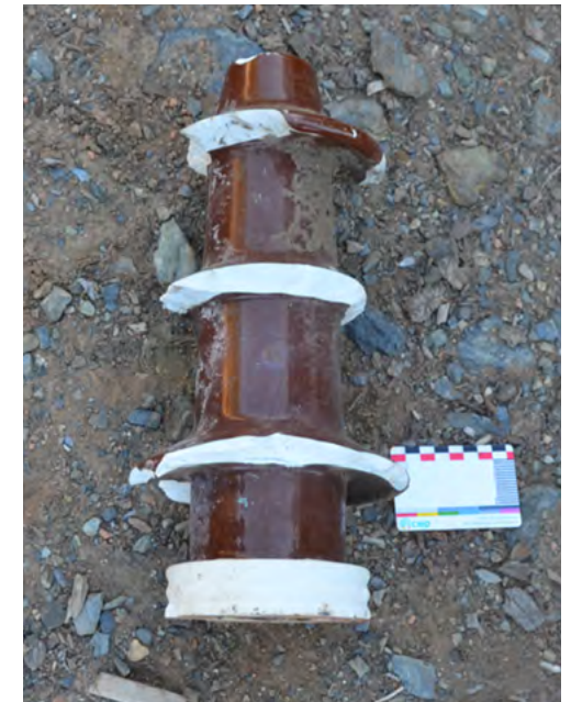
AISSLADOR DE LOZA VIDRIADA HALLADO EN SUPERFICIE EN MINA ESCONDIDA. SE UTILIZABA PARA PERMITIR EL PASO DEL CABLE QUE CONDUCE LA ELECTRICIDAD, POR LOS POSTES, PERO SIN TOCARLOS. MINA ESCONDIDA, PUERTO GUADAL, REGIÓN DE AYSÉN 2024. FOTOGRAFÍA: JAVIERA LETELIER COSMELLI.
